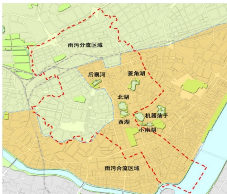
图 3.3-1 江汉区雨污合流分区图
